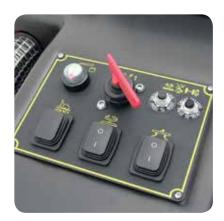
Pannello comandi analogico, semplice ed intuitivo. Selettore di regolazione velocità. Interruttore generale ON/OFF e interruttore a chiave, interruttore per motore spazzola e aspirazione. Disgiuntore termico per proteggere il motore spazzole e aspirazione, indicatore livello batteria, contaore.
