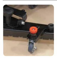
Leva di controllo per l'attivazione spazzola e flusso delle soluzione detergente. Sistema di scarico acqua. Attacco rapido per carica batterie.
