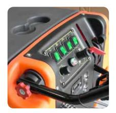
Leva di comando per azionamento spazzola ed erogazione soluzione detergente. Chiave per accensione/ spegnimento ed esclusione batteria, interruttore motore spazzole e motore aspirazione, manopola per dosare detergente (optional), disgiuntore termico per proteggere il motore spazzole e aspirazione, indicatore livello batteria, contaore (optional).
